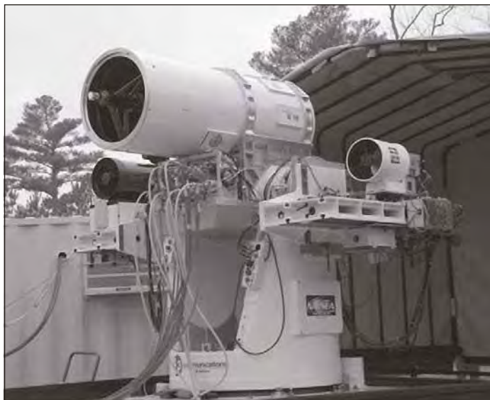
Рис. 1.9. Корабельный лазер LaWS ВМФ США обеспечивает обнаружение, захват, сопровождение и поражение цели
