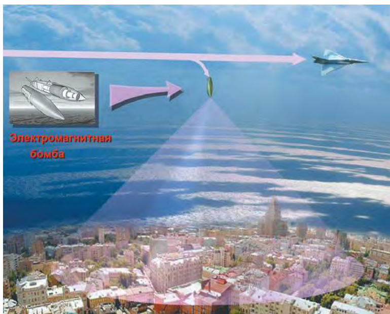
Рис. 2. Электромагнитный боеприпас генерирует поток радиочастотного электромагнитного излучения, выводящий из строя электронные средства противника
