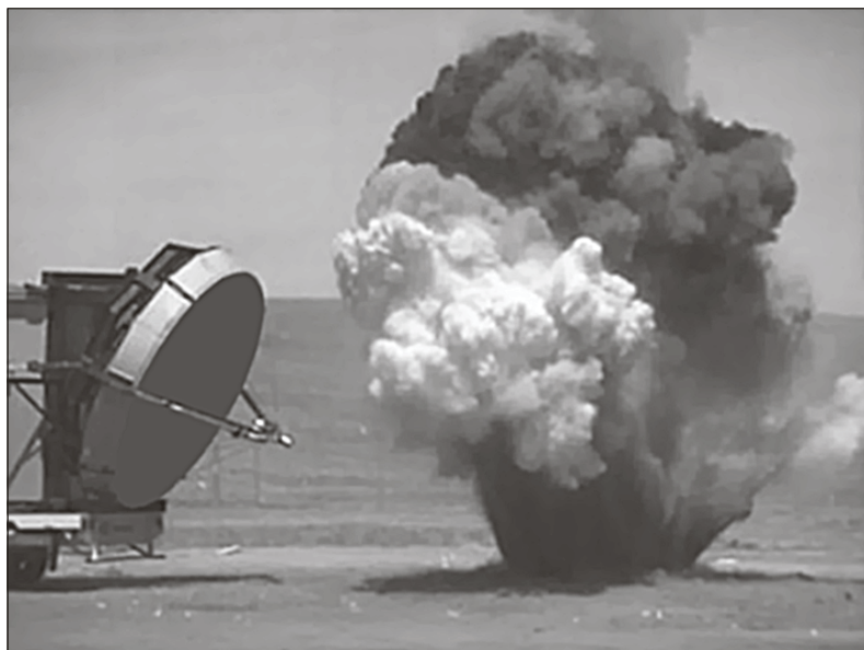
Рис. 1.8. Воздействуя потоком микроволнового излучения, можно не только повредить электронные схемы взрывных устройств, но и спровоцировать их взрыв, прежде, чем это сделает противник с помощью дистанционного взрывателя
