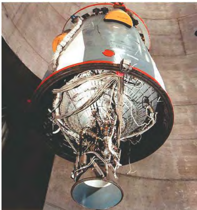
Рис. 23. Головная часть межконтинентальной баллистической ракеты «Булава», объединенная с третьей ступенью
